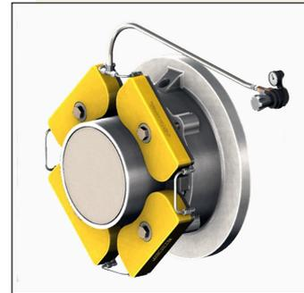
L'AMPS utilise le Chargement actif pour aider à garantir qu'une charge constante et précise est appliquée au jeu d'anneaux d'étanchéité. Ces actionneurs maximiseront les performances d'étanchéité en effectuant des réglages automatiques continus pour compenser le tassement et l'usure des anneaux d'étanchéité.
